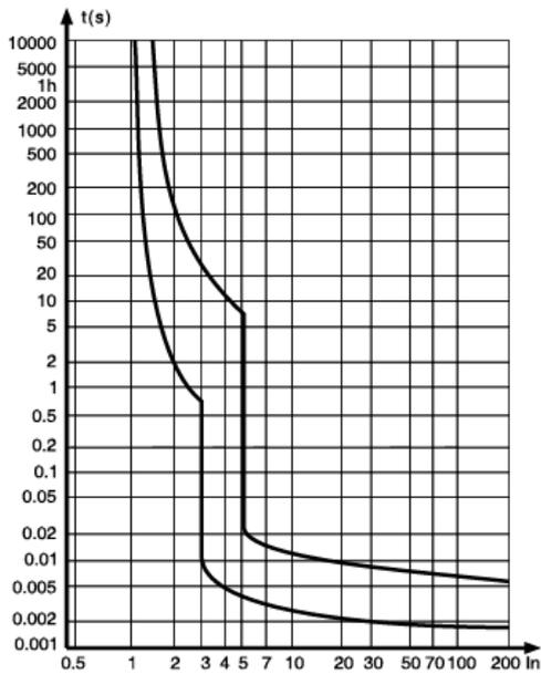
图 1 B 型热/电磁脱扣特性曲线
