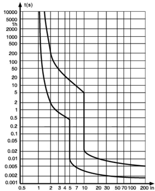
图 2 C 型热/电磁脱扣特性曲线
